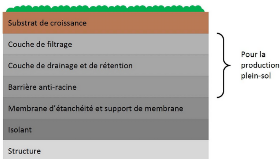
Figure 3 : Composantes de la membrane[39]
